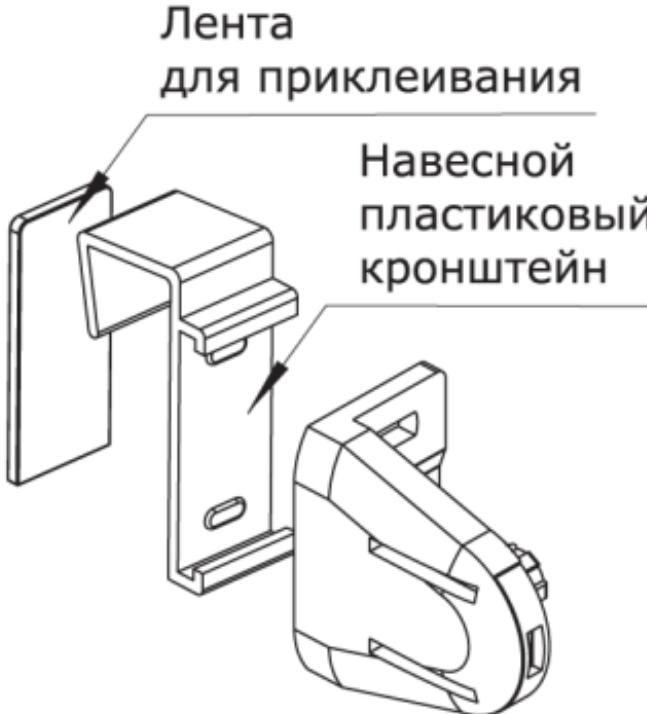
Установка производится только на открывающуюся створку рамы.
